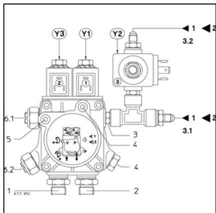
Насос шестеренчатого типа, самовсасывающий. Он должен присоединяться к двум трубопроводам через фильтр для удаления газов. Для соединения между топливной цистерной и фильтром для удаления газов предпочтителен однотрубный вариант. В насосе имеется входной фильтр и регулятор давления топлива. Перед пуском в работу установите манометр для измерения давления **4** и разрежения **5**.
