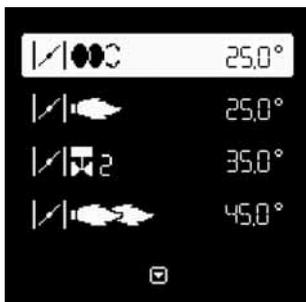
El cajetín abre entonces el modo de ajuste. La pantalla muestra los preajustes de fábrica para las distintas posiciones de la válvula de aire. Aparecen las siguientes posiciones de la válvula de aire:
