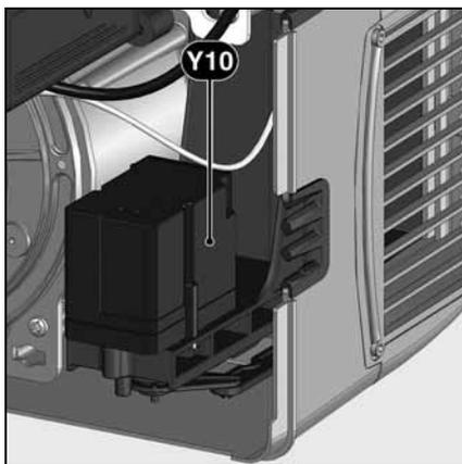
**Регулировка подачи воздуха посредством воздушной заслонки**
