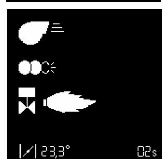
Блок управления ожидает разрешения на регулирование.
